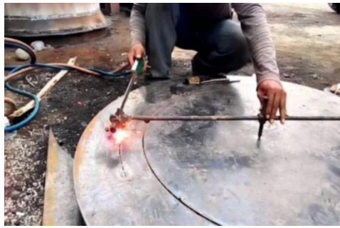
Gambar 2. Proses Pemotongan Bahan
