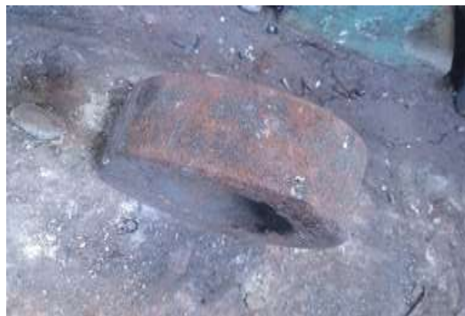
Gambar 5 Produk Logam Tuang Tak Sesuai Ukuran
