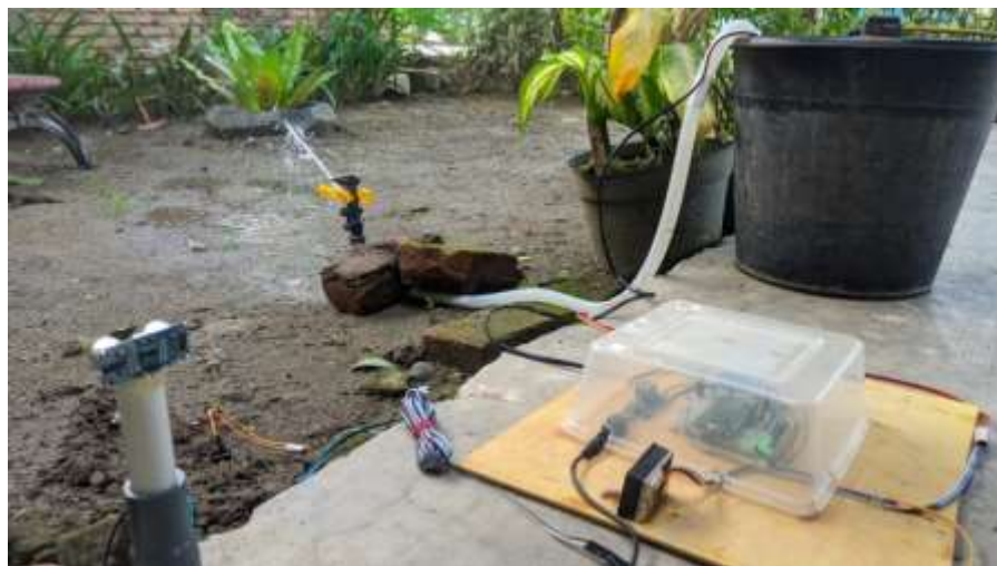
Gambar 7 Penggunaan Alat Penyiraman Jalan Otomatis Berbasis Internet Of Things
