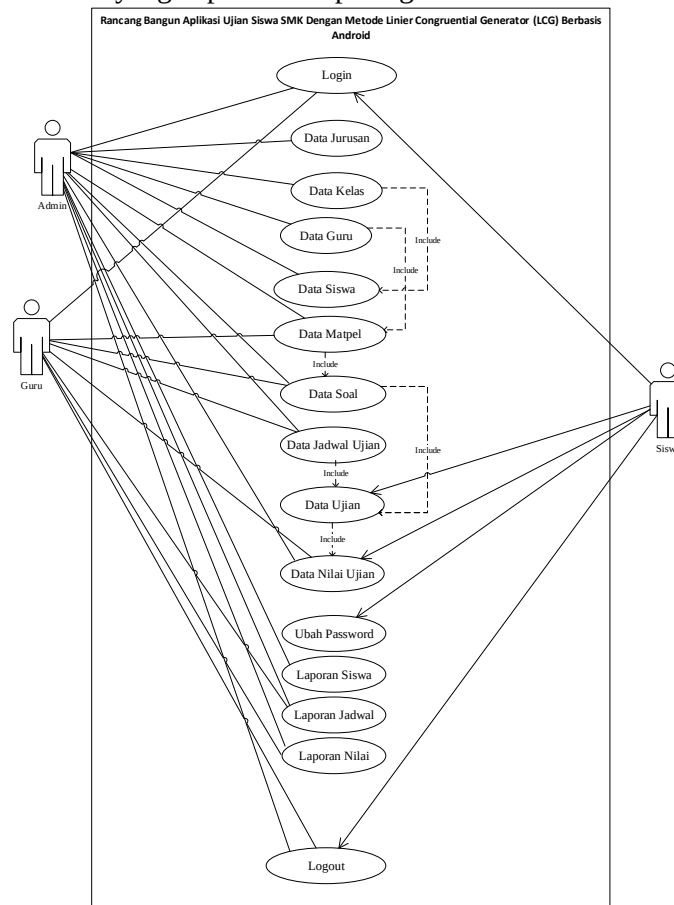
Gambar 3. Use Case Diagram Rancang Bangun Aplikasi Ujian Siswa SMK Dengan Metode Linier Congruential Generator (LCG) Berbasis Android
